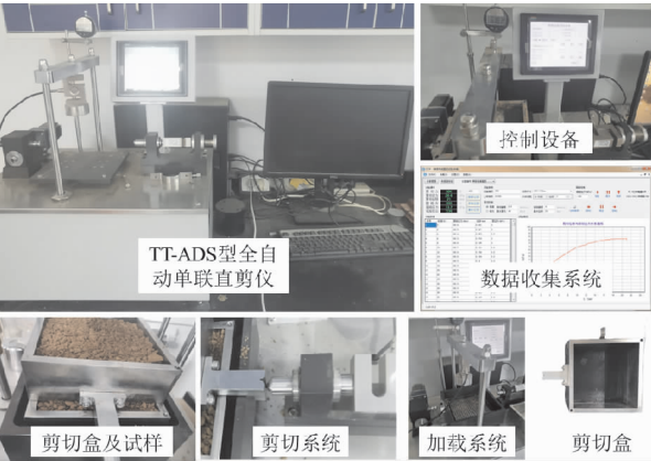
图 5 TT-ADS 型全自动单联直剪仪
